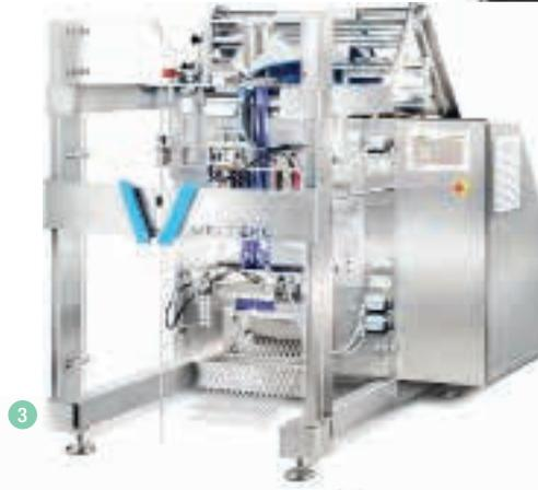
3 L'ensacheuse verticale Prime-360 de Velteko (distribuée par Beaurain MS) est facile à maintenir, grâce à diverses fonctionnalités : centrage automatique du film, diagnostic intégré, détection automatique de fuite d'air comprimé...
